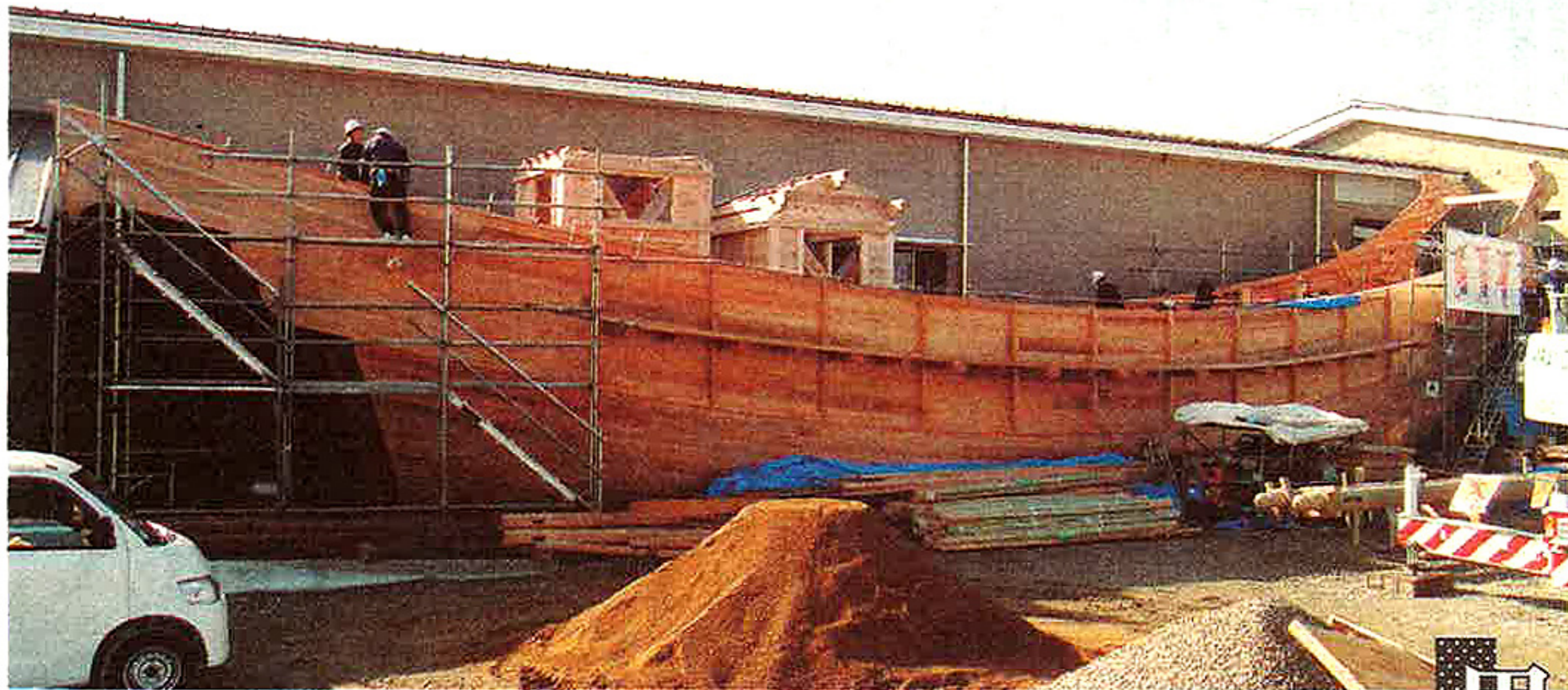
静岡県の造船所から運び込まれ、復元唐使船の甲板に据えられた2つの屋形棟=26日、奈良市の平城宮跡会場予定地で
